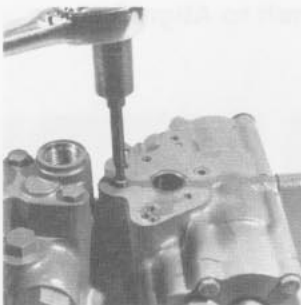
Fig. 79 - Remove Passage Plug
